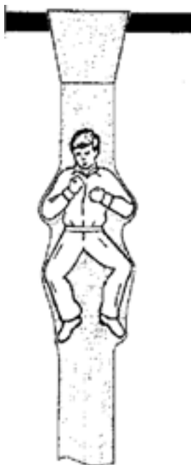
Схема эластичного спасательного рукава
