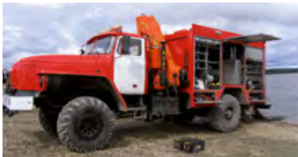
Высокоэнергетическая малогабаритная модульная установка пожаротушения ВЭМ 100/100
