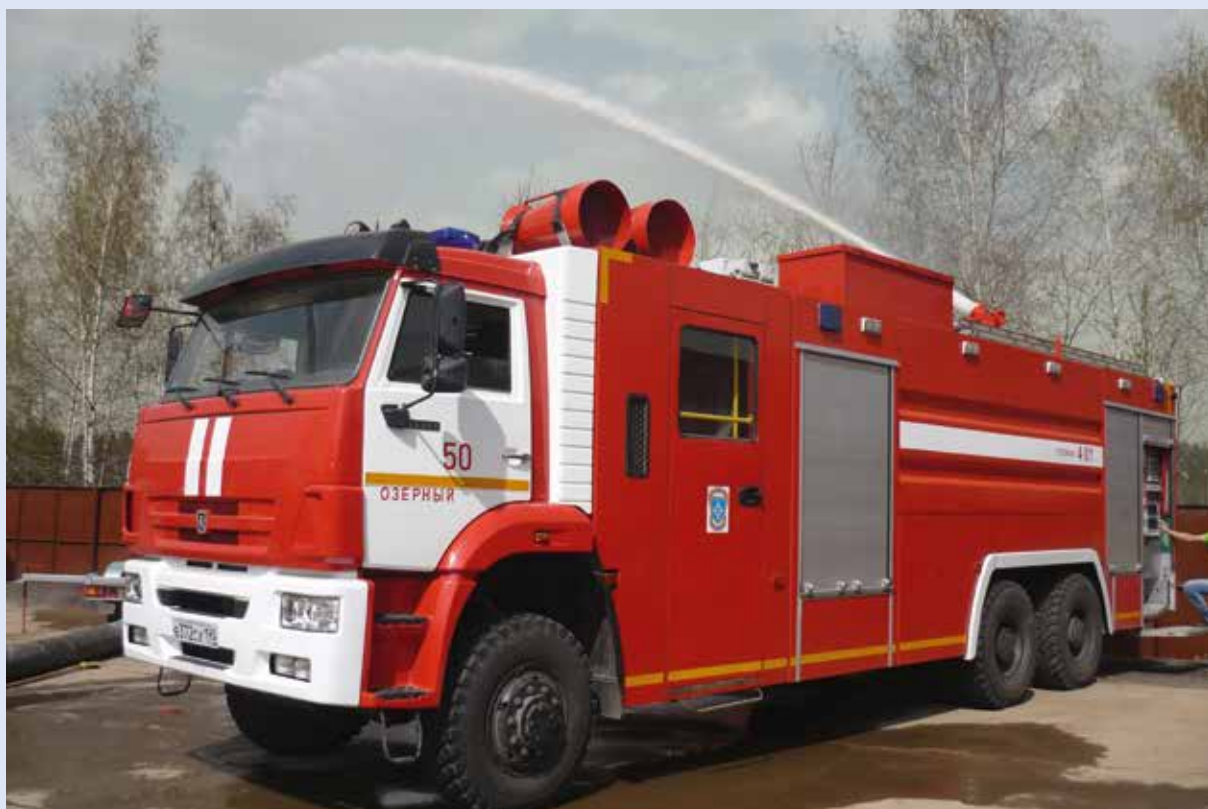
Многофункциональная пожарная автоцистерна с повышенной дальностью подачи средств тушения АЦ 10,0-150
