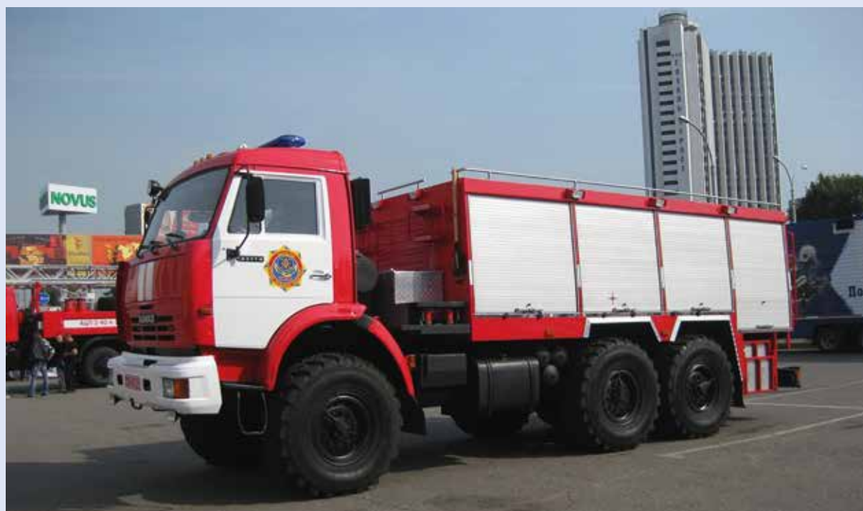
Пожарная насосная станция ПНС-110
