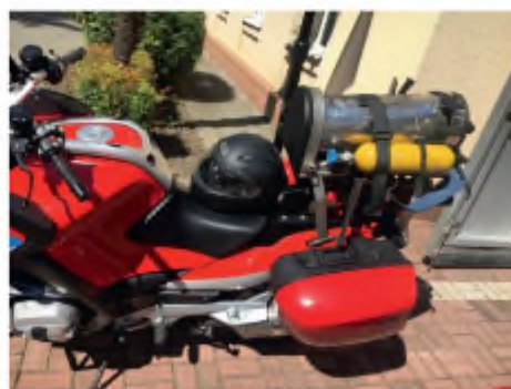
ПСМ на шасси BMW 1200RT (спец. шасси), поставка в составе автокемпера пожарного (на шасси Volkswagen Crafter) типа «Кирасир», СЧЭР, 2012 год
