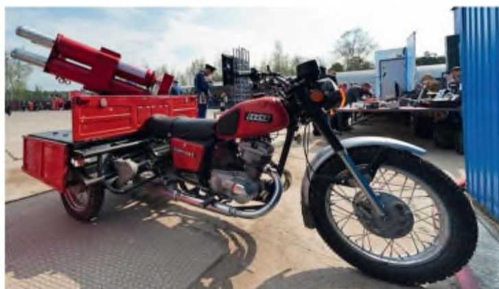
◀ Пожарный мотоцикл ИЖ-6.920-01
