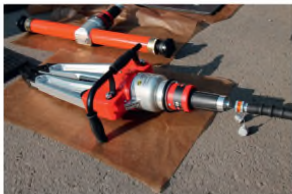
Гидролиния в транспортировочном положении (слева), пример соединения гидролинии и исполнительного гидроустройства (справа)
