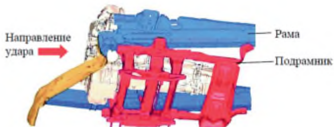
Отсоединяемый подрамник Volkswagen Crafter (вид снизу слева)
