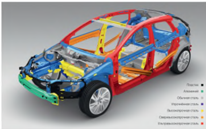
Распределение материалов, используемых в структуре кузова автомобиля
