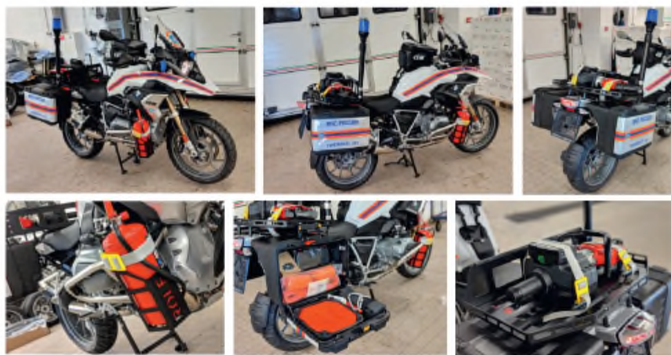
Оснащение аварийно-спасательного мотоцикла МЧС России, 2018 г., BMW R1200 GS
