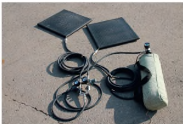
Эластомерный пневдомкрат с редуктором и баллоном со сжатым воздухом
